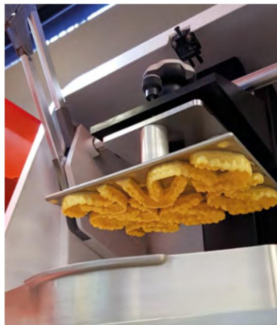
06. Bandeja da impressora 3D DentaForm (Structo, Singapura) com uma sequência de modelos para processamento e termo-estampagem. A DentaForm utiliza uma nova tecnologia chamada MSLA, - Mask Stereolithography (estereolitografia por máscara digital) que permite alta velocidade de impressão mesmo em trabalhos com resolução de 50 micrômetros (XY).
