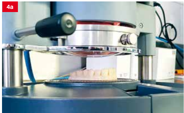
Figura 4a – Placa plástica sendo aquecida para a estampagem do modelo impresso, por meio de equipamentos de última geração Drufosmart (Dreve, Alemanha).
